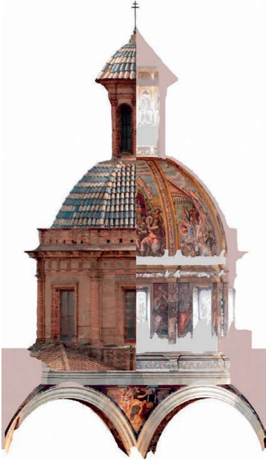
Fig. 9. Levantamiento fotogramétrico de la cúpula de la iglesia del Patriarca. Sección interior y vista exterior.
