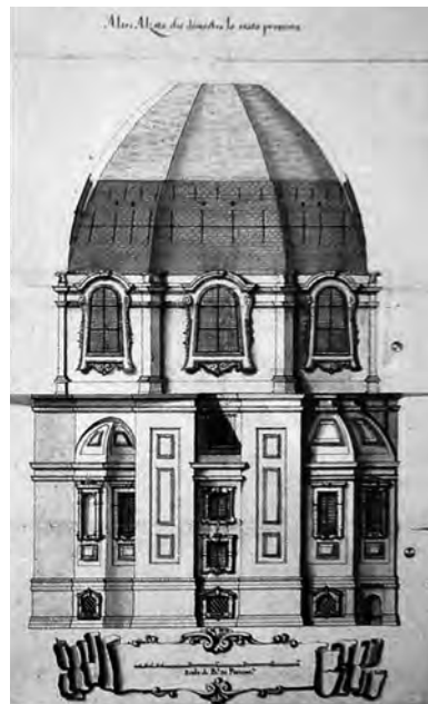
Questa terza calotta viene costruita in aderenza alla struttura preesistente fino alla quota relativa di circa 10,00 m per poi allontanarsi fino a creare un'intercapedine di circa 40 cm. Anonimo, Alzata esteriore della cappella reale di S. Lorenzo, metà del XVIII sec., GDSU 8029°, tav. 1.
