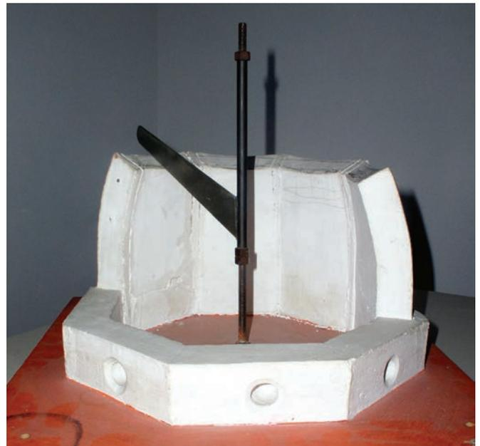
*Fig. 26. Modello di gesso realizzato con la tecnica della randa ruotante con inclinazione prestabilita intorno ad un palo centrale per verificare l'effetto ottico derivante dalla disposizione su letti conici dei mattoni nell'intersezione con la superficie cilindrica della vela (Dipartimento di Costruzioni e Restauro).*
